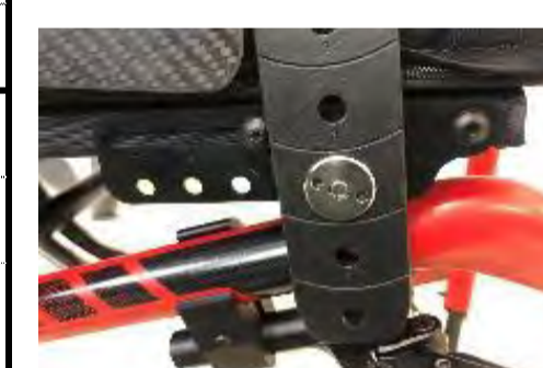
Pas Evoflex regulowany od 35 mm to 125 mm do tyłu od przodu siedziska. 6 pozycji w odstępach co 15 mm
